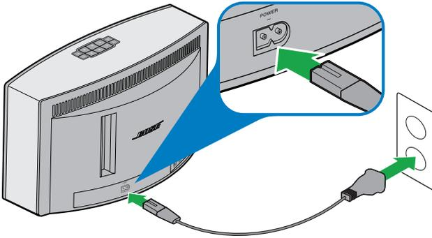
2. Schließen Sie den anderen Stecker des Netzkabels an eine Netzsteckdose an.
